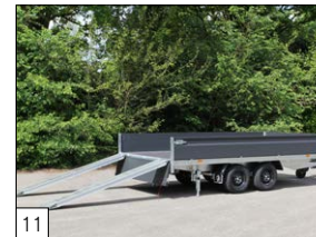
Serienausstattung: 'AUFFAHR'- Paket montiert (Auffahrschienen und Stützen).
