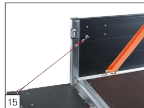
Serienausstattung: vom TÜV zertifiziertes Ladungssicherungssystem von HAPERT: im Seitenrand integrierte Bindebügel 1000 daN.
