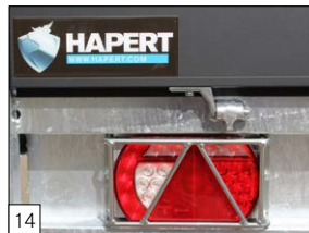
Serienausstattung: Abschirmung der Heckleuchte montiert.
