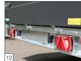
Serienausstattung: LED- Beleuchtung an der Heckseite.
