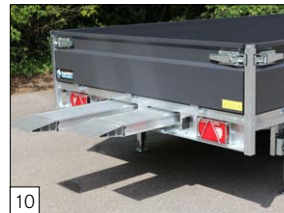
Serienausstattung: 2 integrierte, verstärkte Auffahrschienen aus Aluminium 250cm lang.
