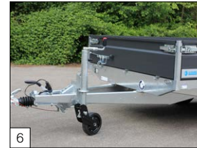
Serienausstattung: verstärktes, klappbares Stützrad montiert.
